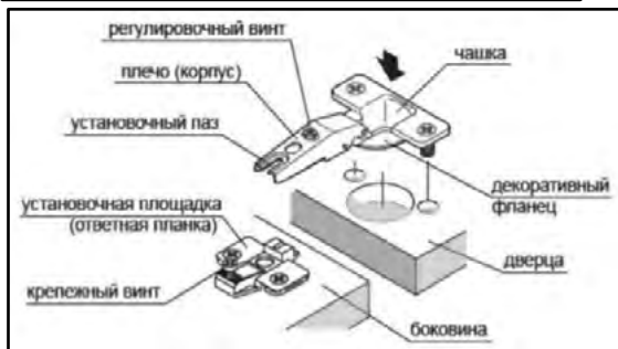
Рис. 2 Установка петель (установка на саморезы 4x16 мм)
